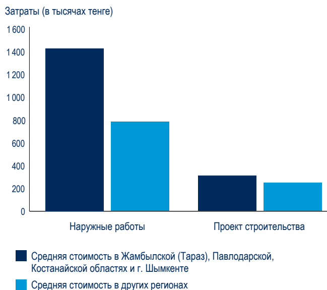
РИСУНОК 5.4 Необходимость установки трансформатора увеличивает стоимость наружных работ почти вдвое, а стоимость проекта по внешнему подключению — на треть
